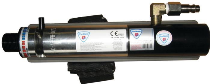
L'air comprimé est tout simplement amené à l'entrée du climatiseur, puis il est refroidi ou chauffé, selon le réglage. Un levier coulissant permet de basculer l'unité en mode refroidissement ou en chauffage. Fourni avec une ceinture ajustable, l'opérateur le porte à la taille.
