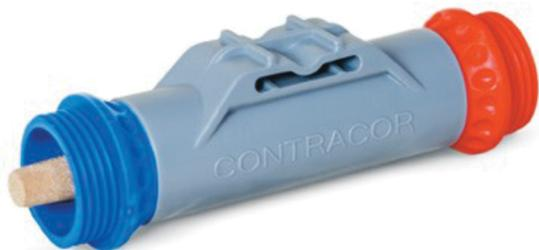
Le climatiseur d'air s'utilise pour réchauffer ou rafraîchir l'air respiré par les utilisateurs dans les cagoules et les casques à grenailage. Il permet d'obtenir des variations de  $\pm 20^{\circ}\text{C}$  par rapport à la température d'arrivée d'air. Le climatiseur d'air fonctionne sans aucune pièce mobile, électricité, fréon ou autres produits chimiques.
