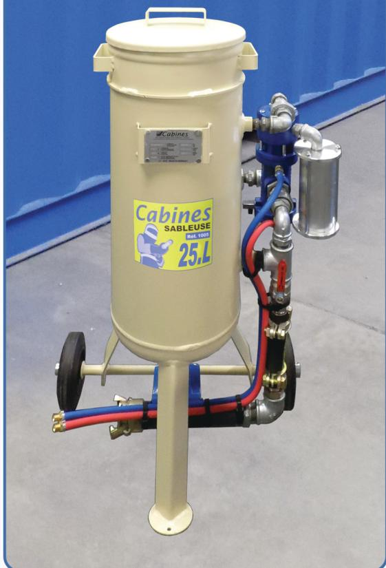
Sableuses très performantes et simple d'utilisation. Elle permettent le sablage au jet abrasif des constructions métallique, bâtiment, ponts, réservoirs, tuyauteries, surfaces en béton etc... Sablage au grade SA-3,0. Performance jusqu'à 28 m<sup>2</sup> / h (voir le tableau), conçues pour travailler avec tous types d'abrasifs à sec, la taille maximum des grains est de 3,5 mm.
