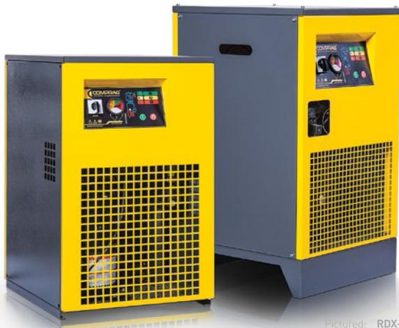
Les sécheurs frigorifiques de la série RDX ayant une capacité de 0,4 à 18,0 m<sup>3</sup>/min sont équipés d'un échangeur de chaleur à plaques en acier inoxydable (RDX04 à 18RDX) ou avec un échangeur de chaleur à ailettes d'aluminium (RDX24 à RDX180), ainsi qu'un séparateur de condensat intégré en acier inoxydable.
