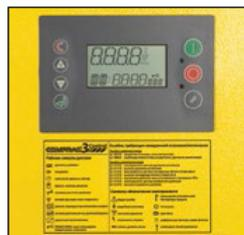
Die professionelle Steuerung ermöglicht es mehrere Kompressoren, in einem System, zu kombinieren und extern zu steuern.
