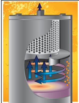
Das meiste Öl wird durch die Zentrifugalkraft, oder die Gravitationskraft im Separator abgeschieden. Das restliche Öl wird von einem qualitativ hochwertigen Luft-Ölabscheider aufgefangen.
